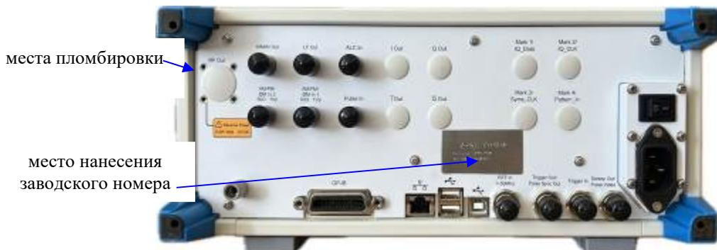
Рисунок 2 – Внешний вид генератора (вид сзади)
