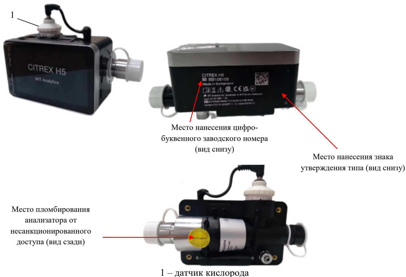
Рисунок 1 – Общий вид анализатора с указанием места нанесения знака утверждения типа, места нанесения цифро-буквенного заводского номера и места пломбирования от несанкционированного доступа
