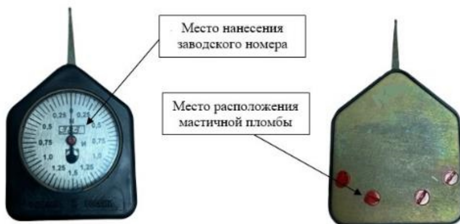
Рисунок 1 – Общий вид средства измерений с указанием места нанесения заводского номера и места пломбировки от несанкционированного доступа
