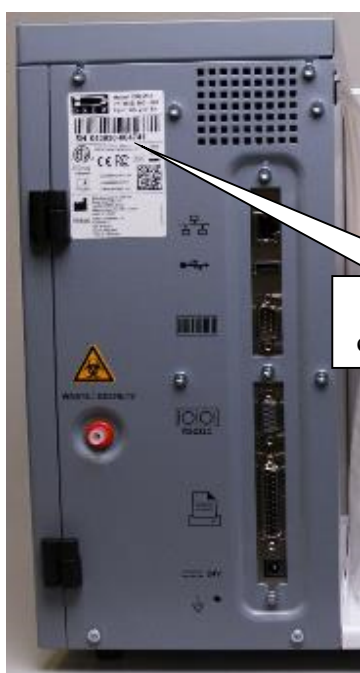
Рисунок 2 – Места нанесения серийного номера и знака утверждения типа
