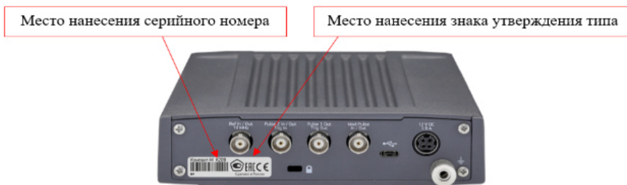
Рисунок 2 – Места нанесения серийного номера, идентифицирующего каждый экземпляр СИ и знака утверждения типа
