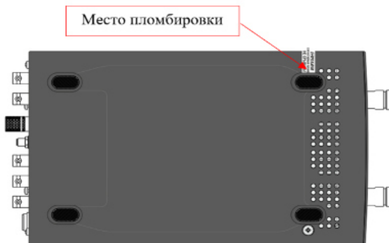
Рисунок 3 – Схема пломбировки от несанкционированного доступа
