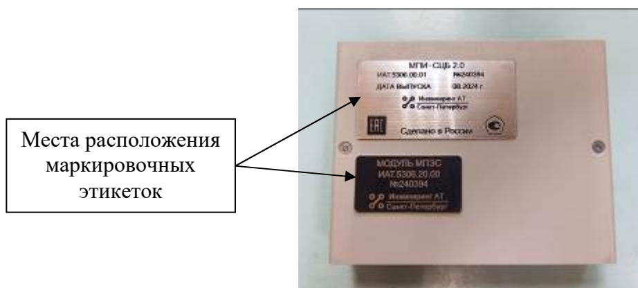
Рисунок 2 – Внешний вид задней поверхности МПЭС с указанием мест расположения маркировочных этикеток
