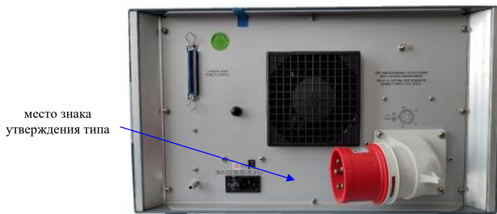
Рисунок 2 – Внешний вид эквивалента сети (вид сзади)
