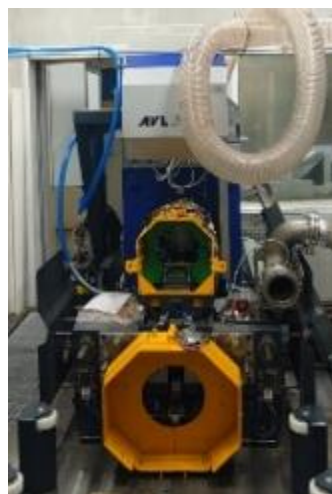
Рисунок 5 – Датчик крутящего момента и датчик частоты вращения коленчатого вала в составе системы нагружения DYNOFORCE ASM 3000/1.8-4.5 с подmotorной плитой и системой пневмоопор
