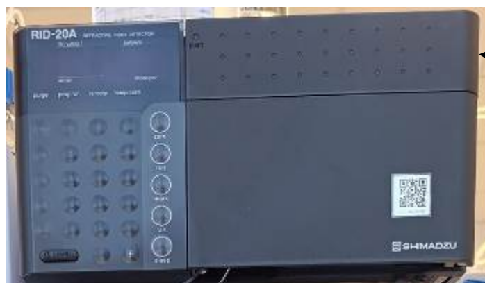
Рисунок 2 – Общий вид рефрактометрического детектора RID-20A
