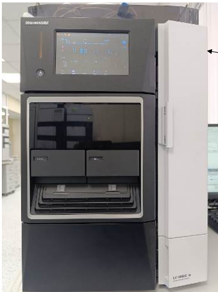
Рисунок 1 – Общий вид хроматографов жидкостных LC-2050C
