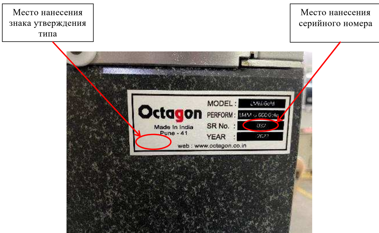
Рисунок 3 – Места нанесения знака утверждения типа и серийного номера на маркировочную наклейку приборов модификации LMM Gold
