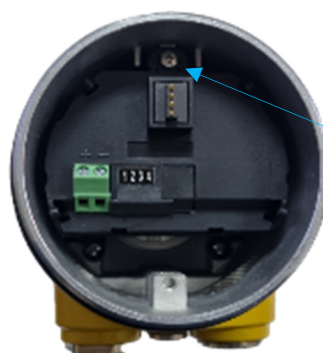
Рисунок 3 – Место пломбирования уровнемеров
