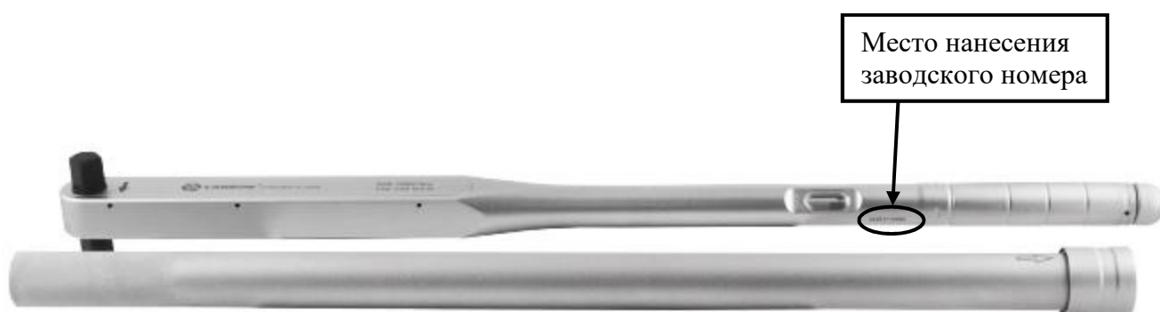
Рисунок 2 – Общий вид ключей моментных предельных СТW модификаций СТWABD-4-1000, СТWABD-5-1500, СТWABD-5-2000 с местом указания заводского номера
