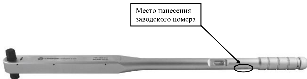
Рисунок 1 – Общий вид ключей моментных предельных СТW модификаций СТWABD-3-120, СТWABD-3-200, СТWABD-3-300, СТWABD-4-550, СТWABD-4-760 с местом нанесения заводского номера
