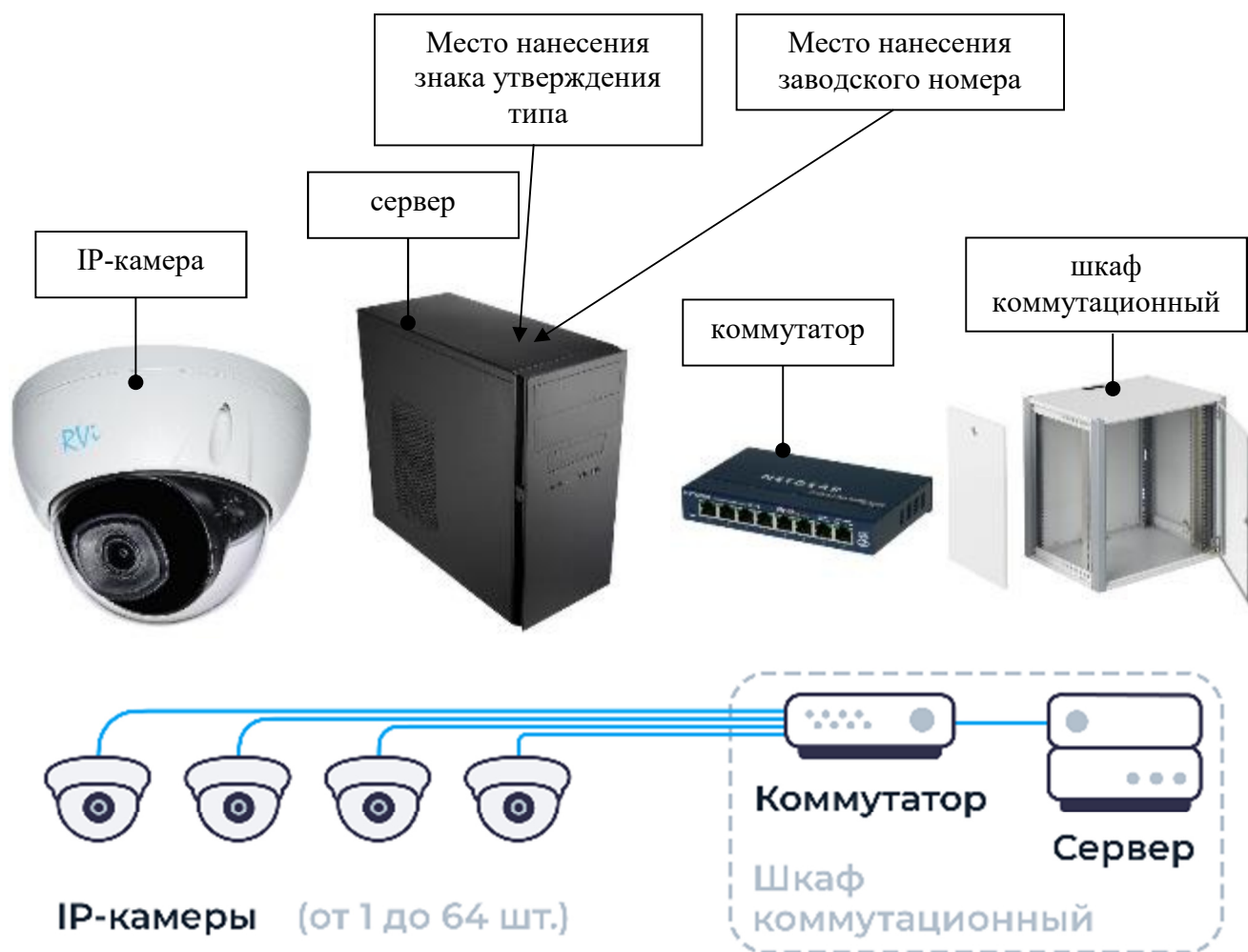
Рисунок 1 – Общий вид систем с указанием места нанесения знака утверждения типа, места нанесения заводского номера
