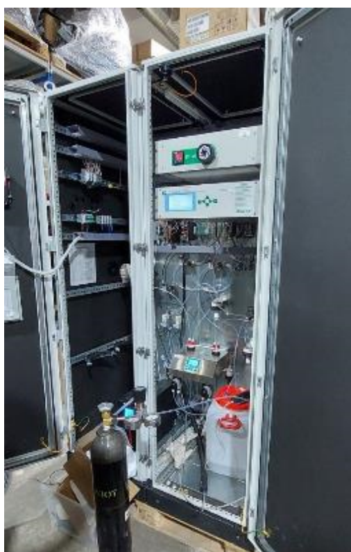
Рисунок 2 – Внутреннее устройство шкафа системы с газоанализатором
