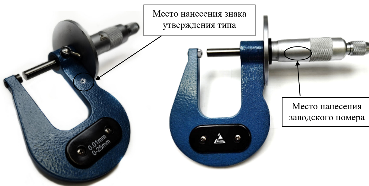
Рисунок 5 – Общий вид микрометров типа MJ с отсчетом показаний по шкалам стебля и барабана, с указанием места нанесения заводского номера и знака утверждения типа
