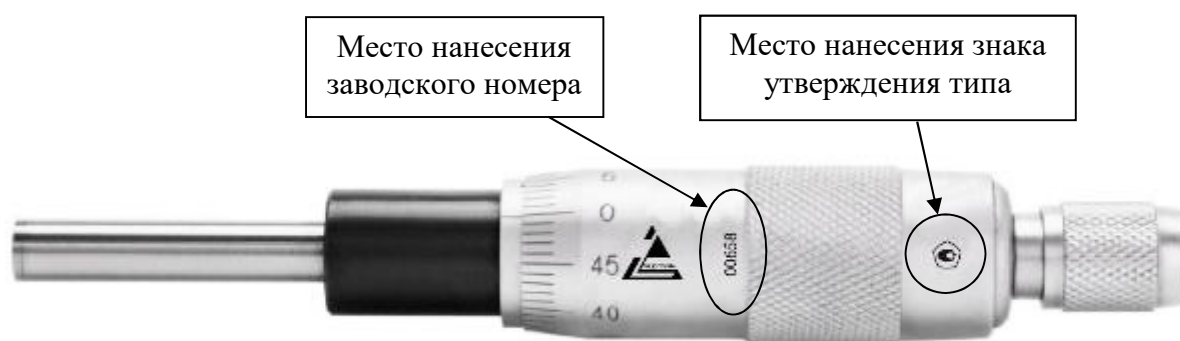
Рисунок 14 – Общий вид микрометров типа МГ с отсчетом показаний по шкалам стебля и барабана, с указанием места нанесения заводского номера и знака утверждения типа
