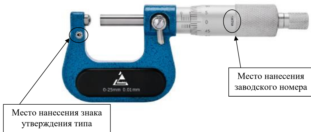
Рисунок 7 – Общий вид микрометров типа МТ с отсчетом показаний по шкалам стебля и барабана, с указанием мест нанесений заводского номера и знака утверждения типа
