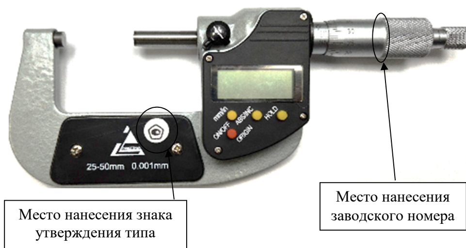
Рисунок 3 - Общий вид микрометров типа МК с отсчетом показаний по электронному цифровому устройству, с указанием мест нанесений заводского номера и знака утверждения типа
