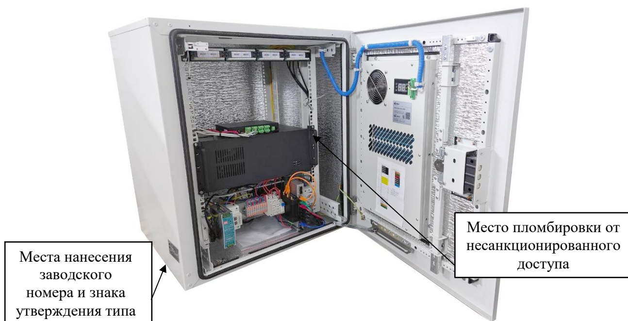
Рисунок 3 – Схема пломбировки от несанкционированного доступа комплексов модификации 1 и 2
