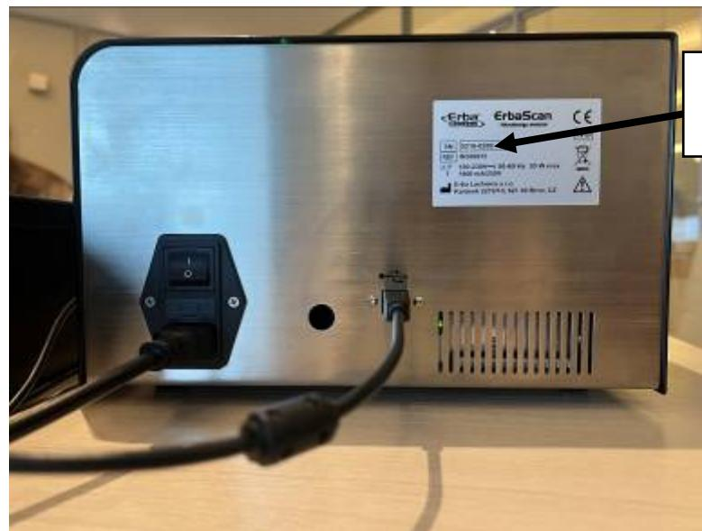
Рисунок 2 – Общий вид, схема маркировки анализаторов
