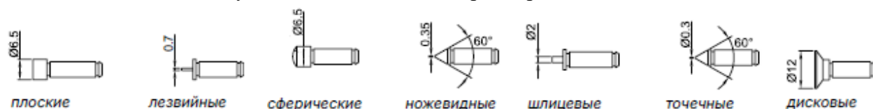
Рисунок 3 – Варианты сменных измерительных наконечников для микрометров моделей 2710, 2730
