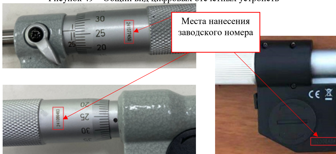
Рисунок 50 – Обозначение мест нанесения заводского номера на микрометры
