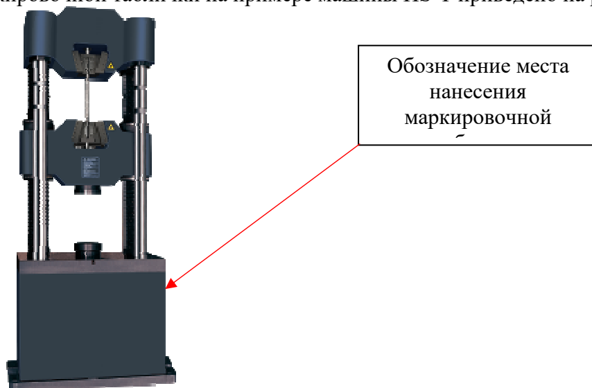
Рисунок 5 - Обозначение места нанесения маркировочной таблички на примере машины HS-T
