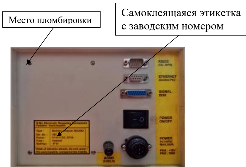
Рисунок 2б – Общий вид баллистического анализатора BA04S2, место размещения самоклеящейся этикетки с заводским номером, место пломбировки.
