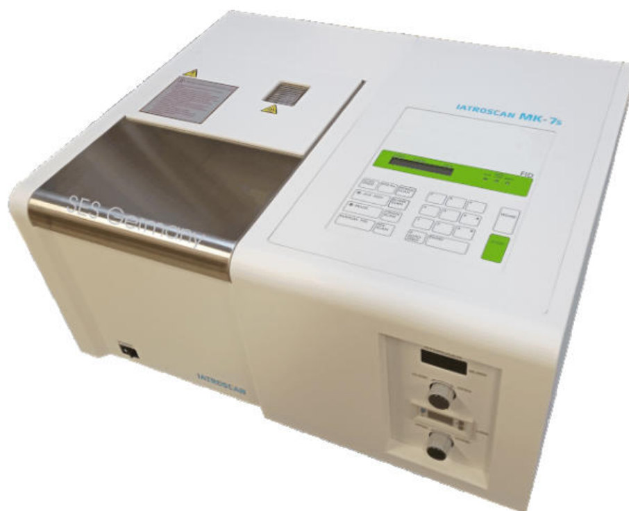
Рисунок 1 – Общий вид прибора тонкослойной хроматографии IATROSCAN MK-7s
