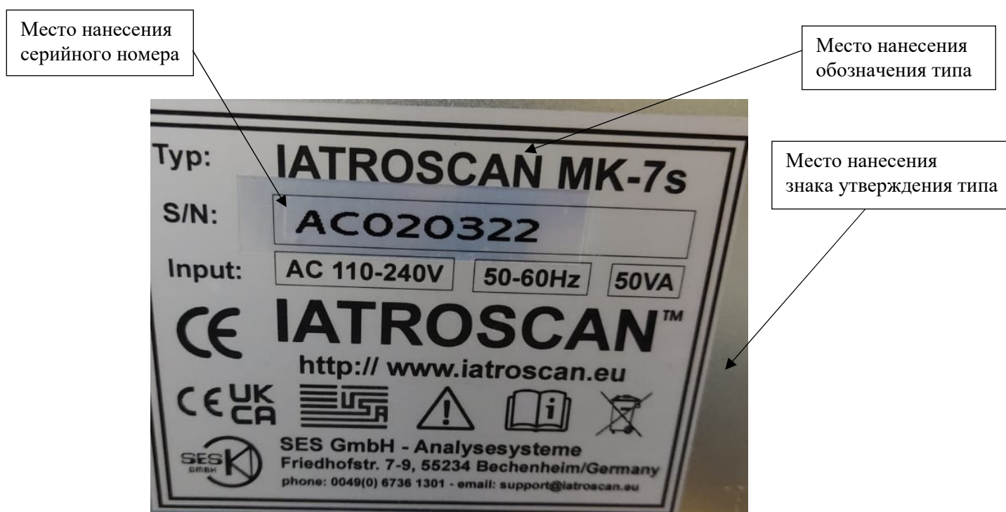
Рисунок 2 – Вид информационной таблички (шильда) с обозначением типа прибора и серийным номером
