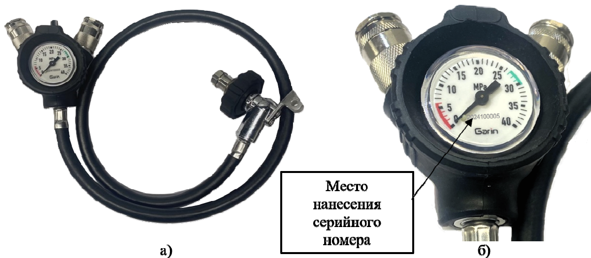
Рисунок 1 – Общий вид манометров: а) вид манометров с удлинительным шлангом и соединительным приспособлением; б) место нанесения серийного номера
