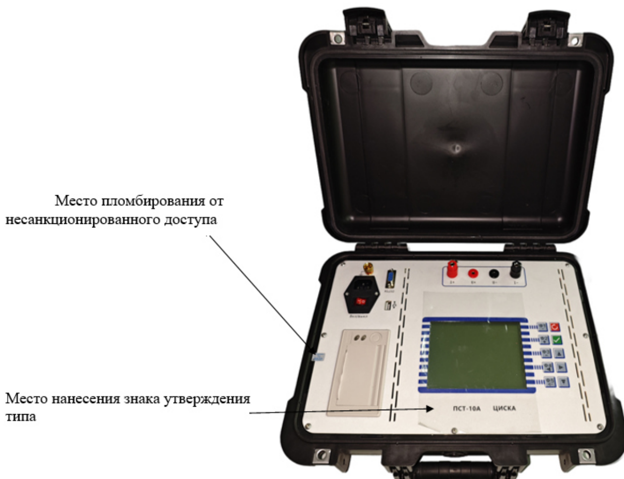
Рисунок 3 - Место пломбирования от несанкционированного доступа и место нанесения знака утверждения типа
