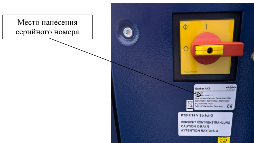
Рисунок 2 – Вид паспортной таблички спектрометра с указанием места нанесения серийного номера
