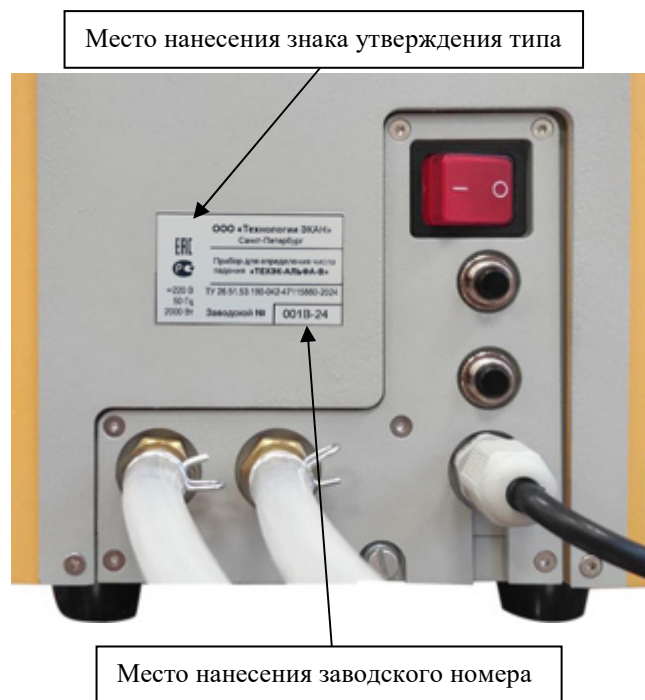
Рисунок 2 – Общий вид задней панели приборов для определения числа падения ТЕХЭК-АЛЬФА
