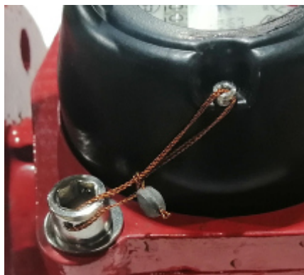
Рисунок 3 – Схема пломбирования от несанкционированного доступа, обозначение места нанесения знака поверки счетчиков
