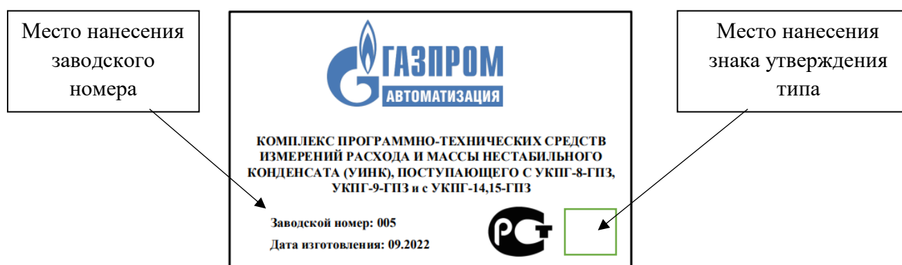
Рисунок 3 – Вид маркировочной таблички с указанием места нанесения заводского номера и знака утверждения типа
