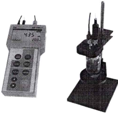
Рисунок 1.3 – Фотографии общего вида рХ-метра рХ-150.1
