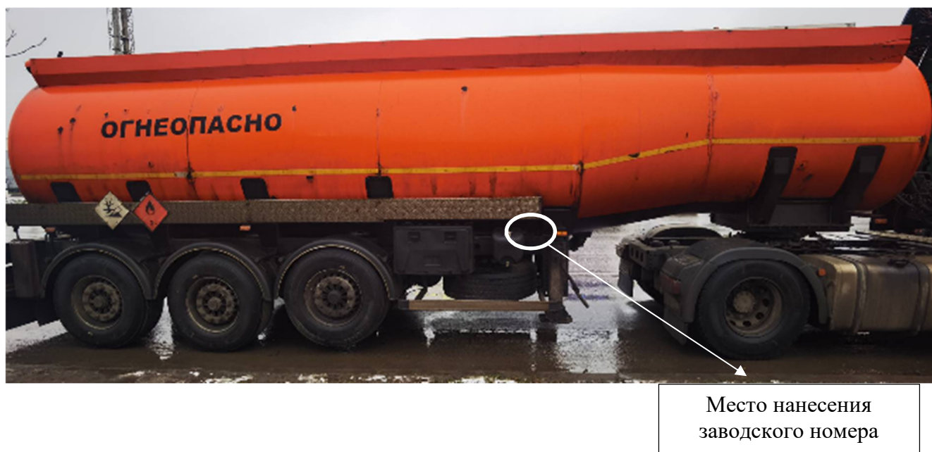
Рисунок 1 – Общий вид полуприцепа-цистерны TANSAN и место нанесения заводского номера
