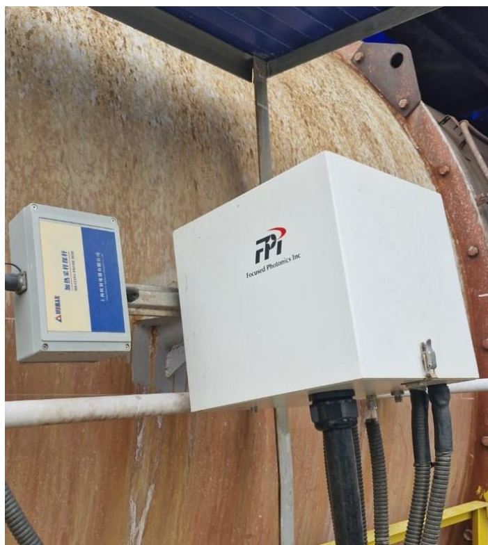
Рисунок 3 – Общий вид нагреваемого пробоотборного зонда FP-3000
