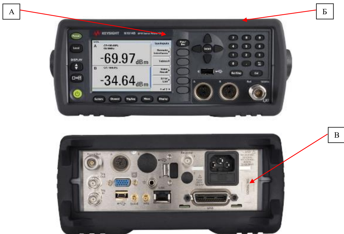
Рисунок 1 – Общий вид блоков измерительных, места нанесения знака утверждения типа (А), знака поверки (Б) и инвентарного номера (В)
