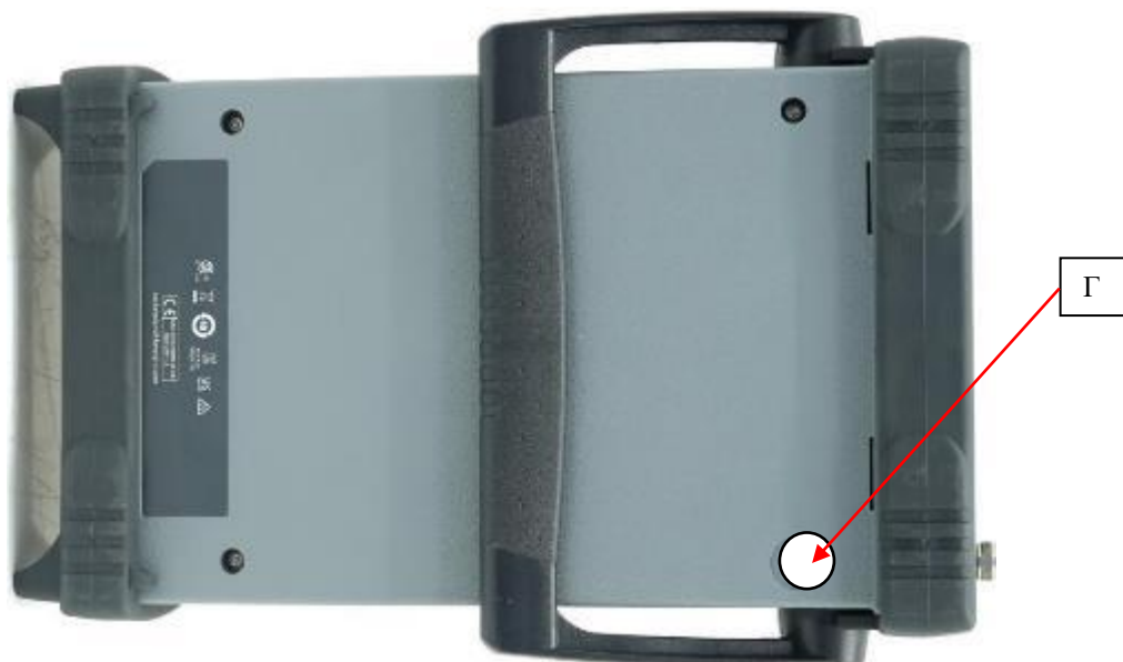
Рисунок 2 – Схема опломбирования от несанкционированного доступа (Г)
