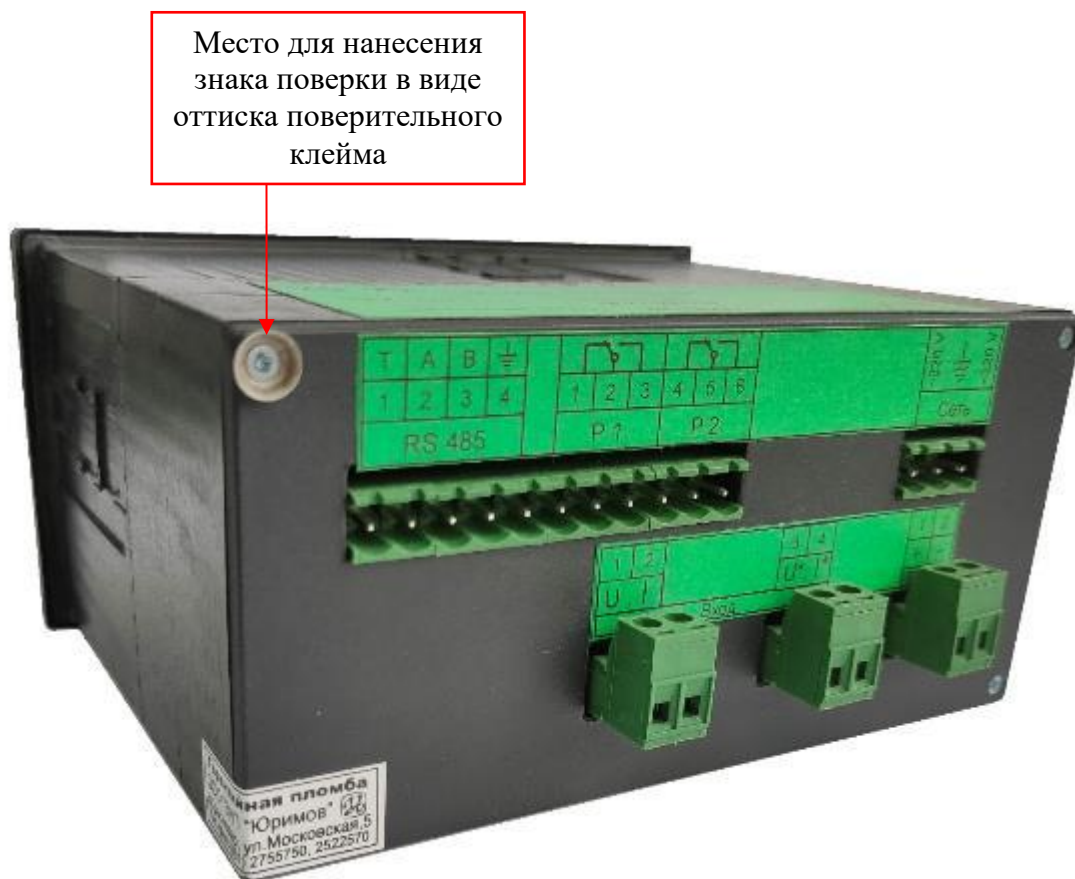
Рисунок 8 – Фотография общего вида измерителя Е160.3 с указанием места нанесения знака поверки в виде оттиска поверительного клейма, нанесенного на мастичную пломбу, закрывающую доступ к винту крепления верхней крышки корпуса измерителя
