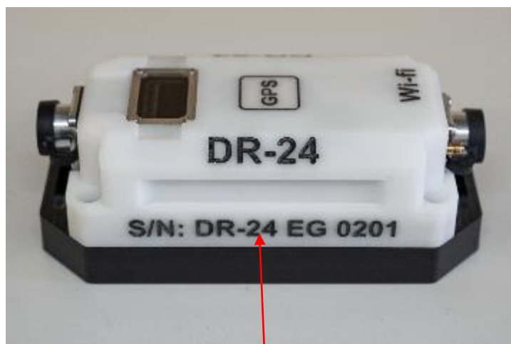
Рисунок 1 – Общий вид виброскопа DR-24 исполнение DR-24 EG
