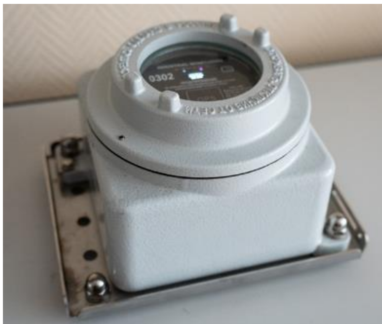
Рисунок 3 – Общий вид виброскопа DR-24 исполнение DR-24 Ex
