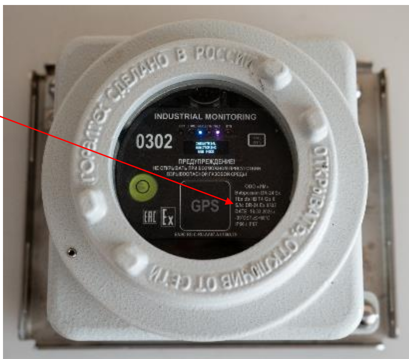
Рисунок 4 – Место нанесения заводского номера виброскопа DR-24 исполнение DR-24 Ex
