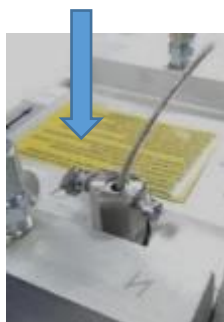
Монтаж термопреобразователя сопротивления Pt500 (500П) в потоке газа
