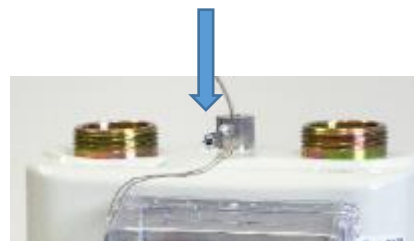
Монтаж термопреобразователя сопротивления Pt500 (500П) в потоке газа
