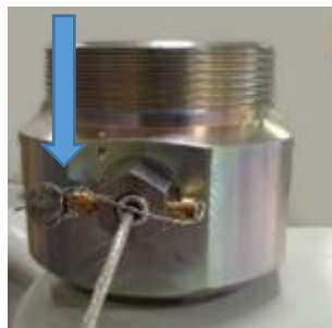
Рисунок 3 – Схема пломбировки от несанкционированного доступа счетчика газа, обозначение места нанесения знака поверки
