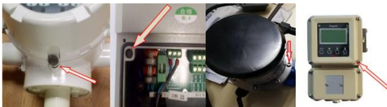
Рисунок 3 – Схема пломбировки от несанкционированного доступа и обозначение места нанесения знака поверки
