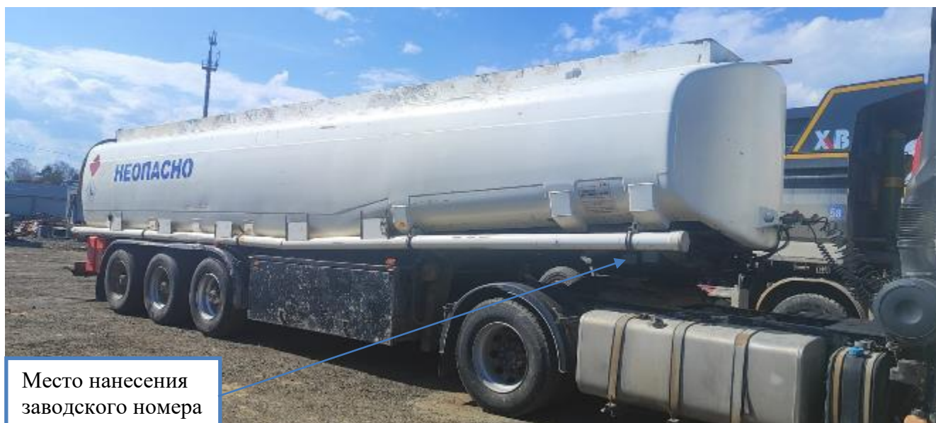
Рисунок 1 – Общий вид полуприцепа-цистерны KAESSBOHRER с указанием места нанесения заводского номера
