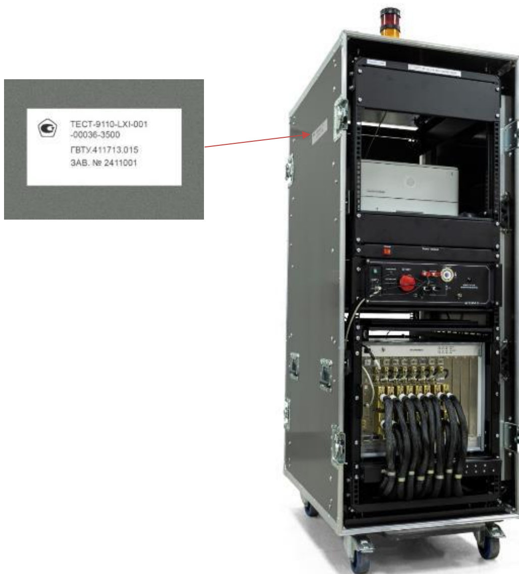
Рисунок 3 – Общий вид систем на основе стандарта LXI и металлизированной самоклеящейся наклейки с заводским номером
