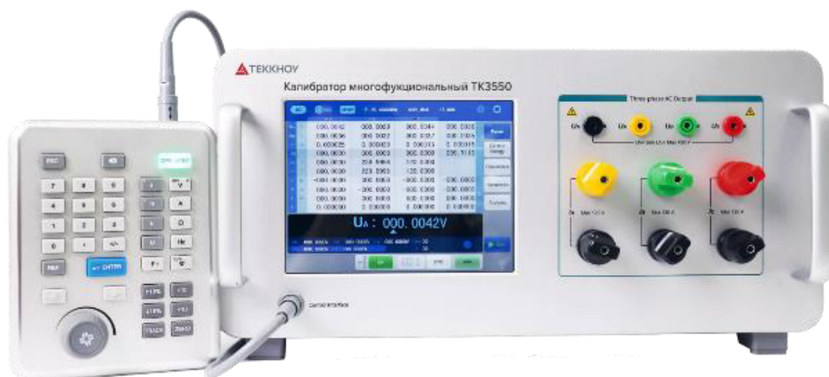
Рисунок 5 – Калибратор многофункциональный трехфазный Теккноу ТК3550
