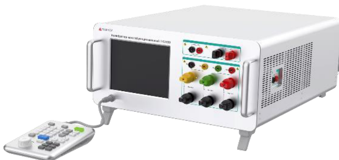
Рисунок 6 – Калибратор многофункциональный трехфазный Теккноу ТК3100
