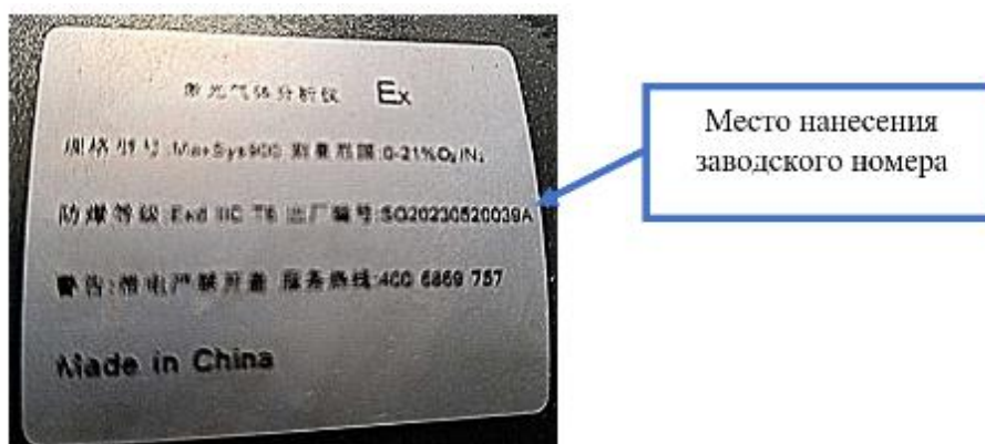
Рисунок 2 – Идентификационная табличка газоанализатора с указанием места нанесения заводского номера
