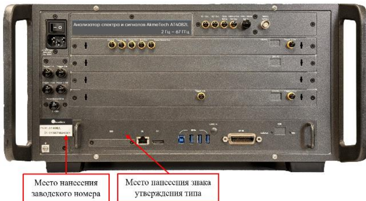
Рисунок 4 – Вид задней панели средства измерений с указанием мест нанесения знака утверждения типа и заводского номера (исполнение AkmeTech AT4082)
