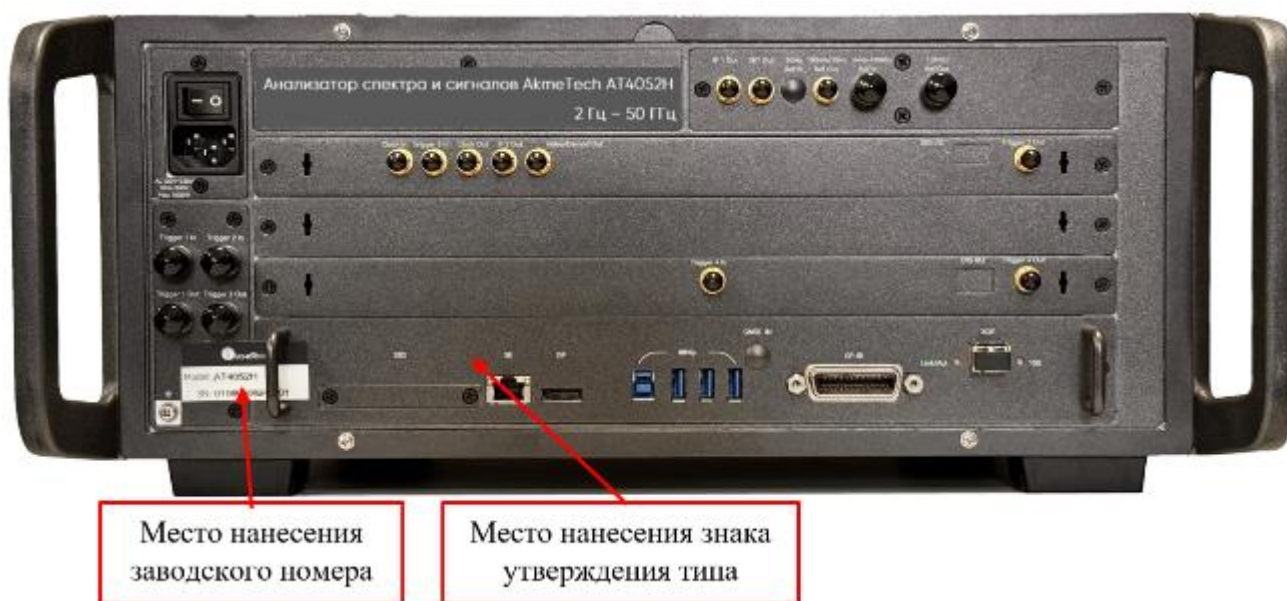
Рисунок 3 – Вид задней панели средства измерений с указанием мест нанесения знака утверждения типа и заводского номера (исполнение AkmeTech AT4052)
