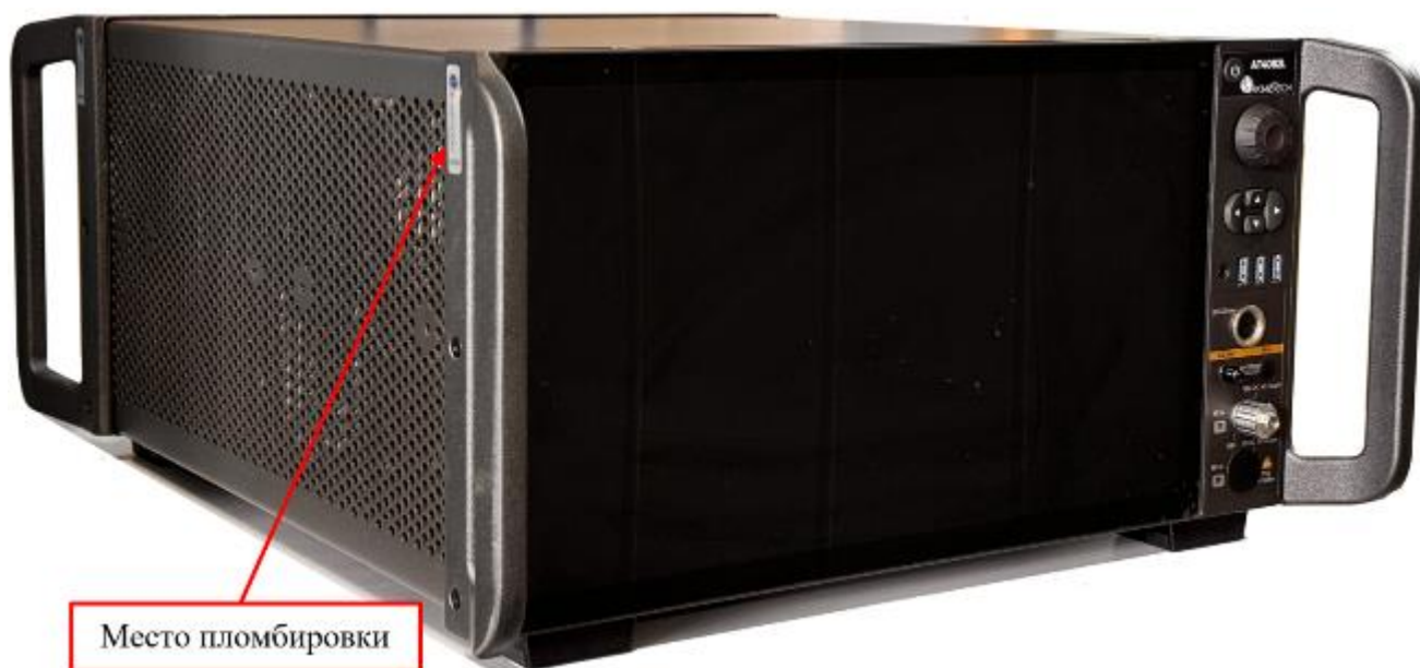
Рисунок 2 – Общий вид средств измерений с указанием места пломбировки (исполнение AkmeTech AT4082)
