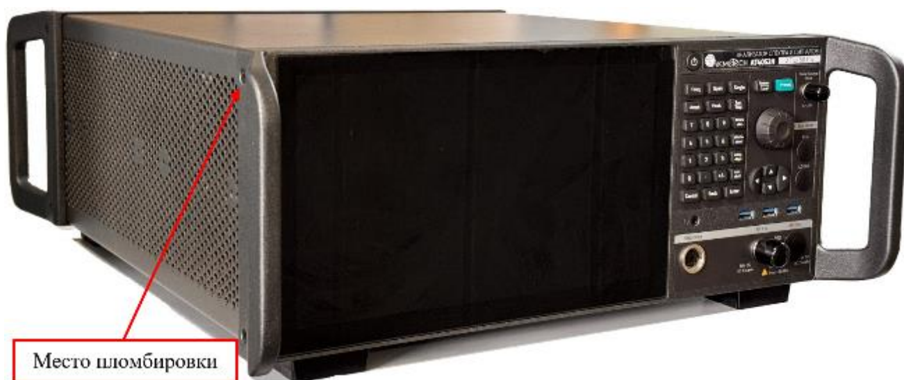
Рисунок 1 – Общий вид средств измерений с указанием места пломбировки (исполнение AkmeTech AT4052)
