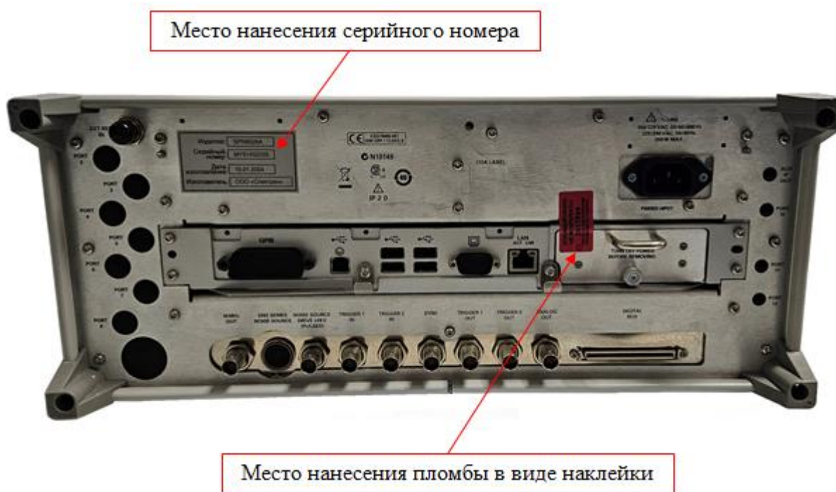
Рисунок 2 – Задняя панель корпуса анализатора сигналов SPN9026A
