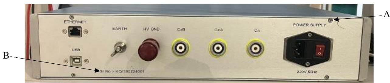
Рисунок 2 – Обозначение мест пломбирования от несанкционированного доступа (А) и нанесения серийного номера (В)
