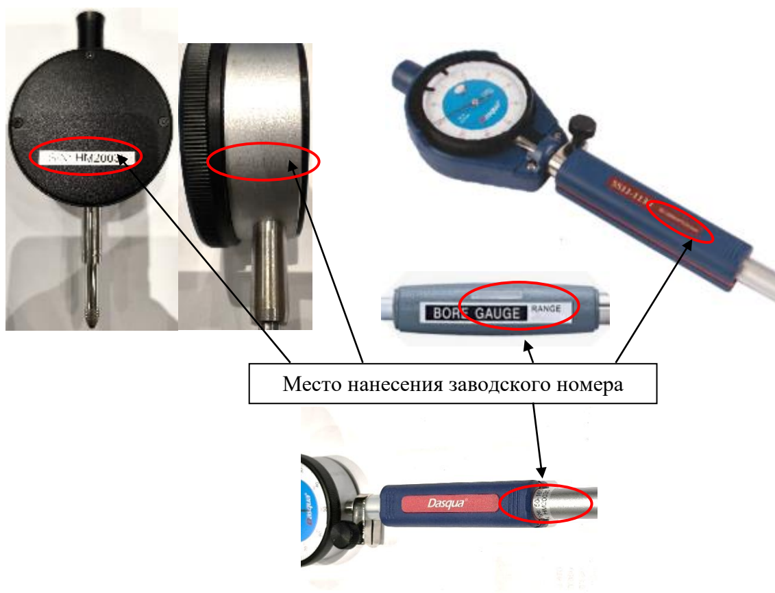
Рисунок 15 – Места нанесений заводских номеров на отсчетное устройство и державку
