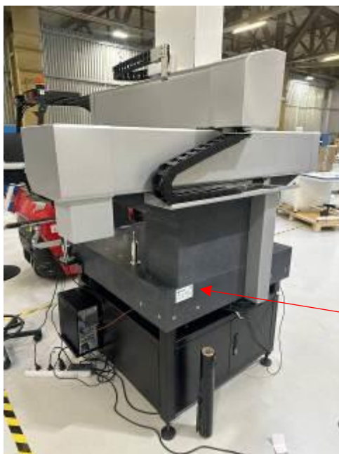
Рисунок 1 – Машины координатно-измерительные NORGAU NCMM Optimal: а) общий вид; б) место нанесения маркировочной наклейки
