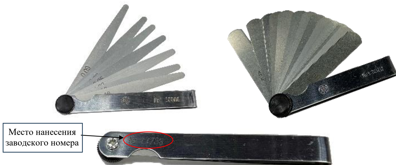
Рисунок 1 – Общий вид щупов с указанием места нанесения заводского номера
