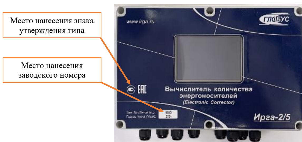
Рисунок 1 – Общий вид вычислителей с указанием мест нанесения знака утверждения типа и заводского номера
