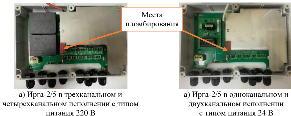
Рисунок 2 – Места пломбирования вычислителей
