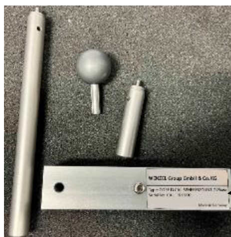
Рисунок 1 – Общий вид мер для поверки систем координатно-измерительных CORE-D модификации CORE-D CAL-SPHEREMOUNT-D25мм с указанием места нанесения серийного номера
