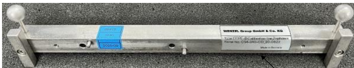
Рисунок 1 – Общий вид мер для поверки систем координатно-измерительных CORE-D модификации CORE-D CAL-SPHEREMOUNT-D25мм с указанием места нанесения серийного номера
