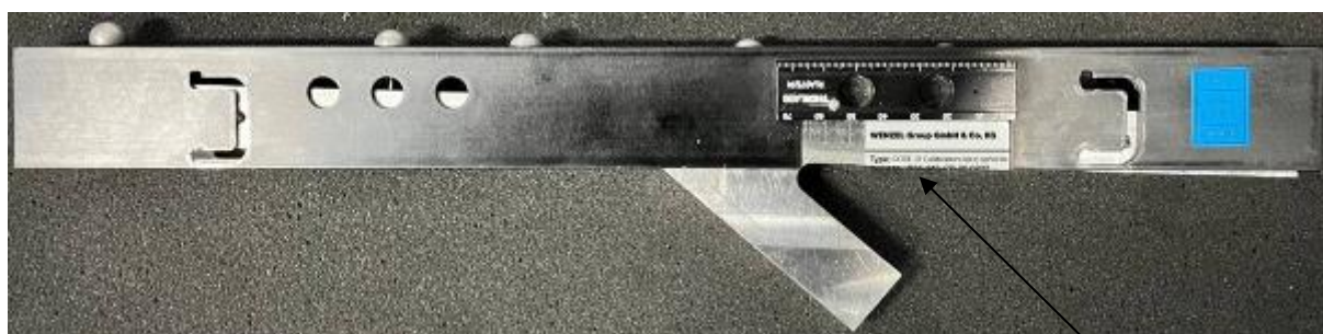
Рисунок 2 – Общий вид мер для поверки систем координатно-измерительных CORE-D модификации CORE-D Calibration bar 2 spheres с указанием места нанесения серийного номера
