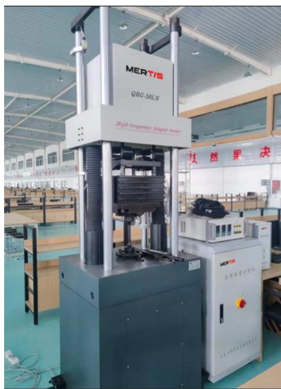
Рисунок 2 – Общий вид машин испытательных MERTIS QBG-20LN, QBG-50 LN, QBG-100 LN, QBG-200 LN, QBG-300 LN, QBG-400 LN, QBG-500 LN, QBG-1000 LN
