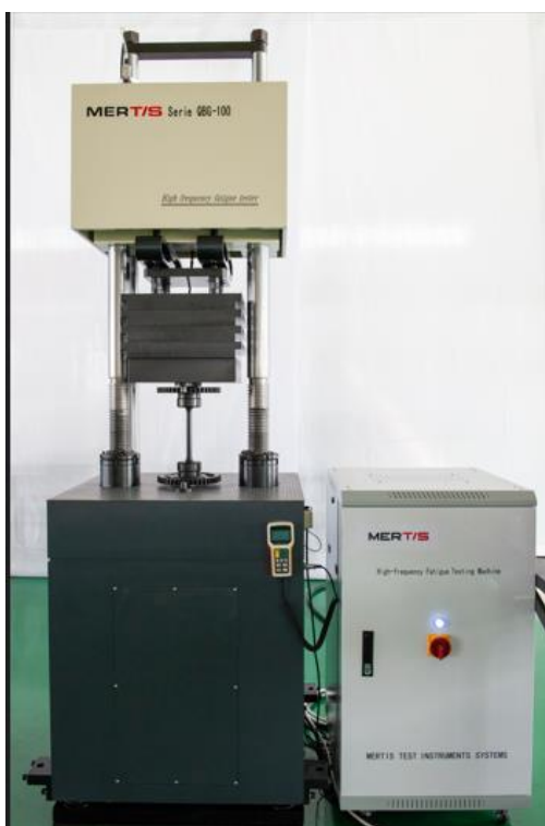
Рисунок 1 – Общий вид машин испытательных MERTIS QBG-20, QBG-50, QBG-100, QBG-200, QBG-300, QBG-400, QBG-500, QBG-1000
