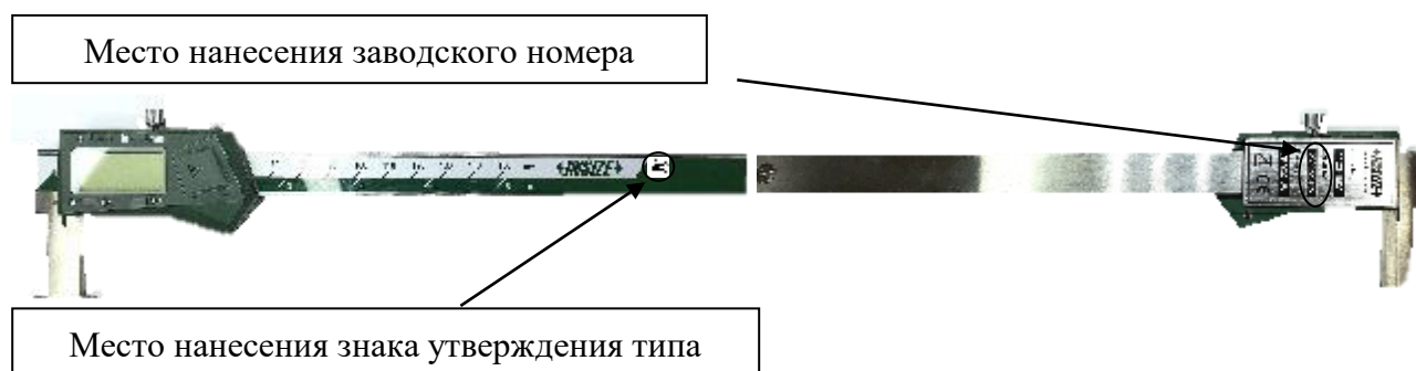
Р и с у н о к 2 – Места нанесения заводского номера и знака утверждения типа
