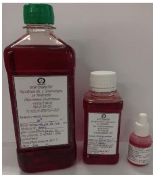
Рисунок 1 – Общий вид мер счетной концентрации частиц в масле МСК-М-125-250
